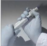
图一：按住脱卸按钮后（Reference 2 需将控制按钮完全按下），拔出套筒
